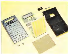
Una vista della TI-55-II aperta con i suoi interni.
